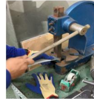
7. T-Bend Adhesion Test
