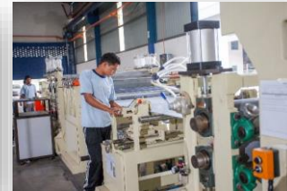
7. Edge trimming to width
